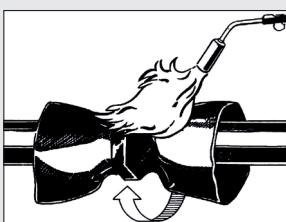
3. Smršťovací hadice se zahřívá měkkým žlutým plamenem propan-butanového hořáku rovnoměrnými pohyby po obvodu, začíná se uprostřed hadice.
