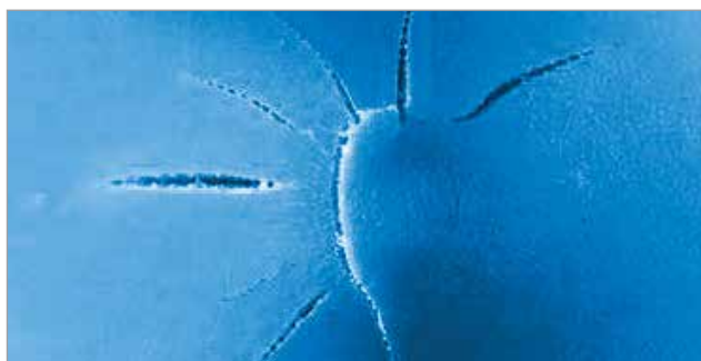
Poškození dlouhodobým působením napětí
